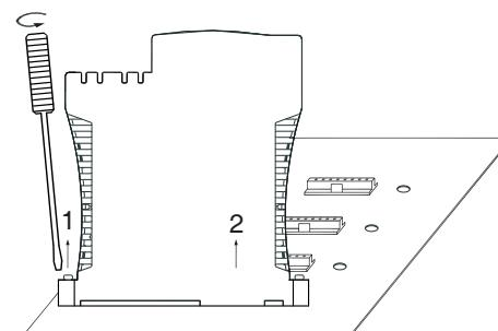
(3) 分离端子上的导线时请将标准的一字螺丝刀，插入橙色的操作位的凹槽内，并向内推入，然后将导线从接线孔内拔出即可。
